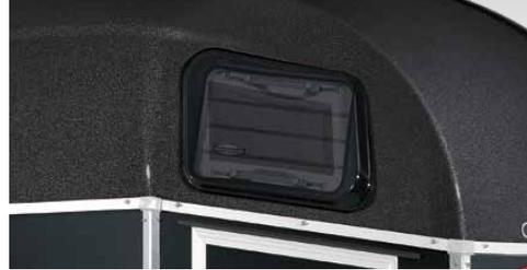
**Frischluft** durch die großen, blendfreien 5-Wege-Fenster (nach vorne, hinten, oben, unten sowie komplett aufstellbar) mit Sicherheitsgitter.
