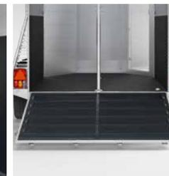
**Sicherer Einstieg** durch den Gummibelag mit Trittleisten und Seitenstopp auf der Hinterklappe.
