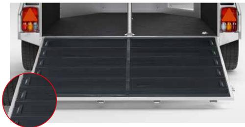
**Sicherer Einstieg** durch den Gummibelag mit Trittleisten und Seitenstopp auf der Hinterklappe.
