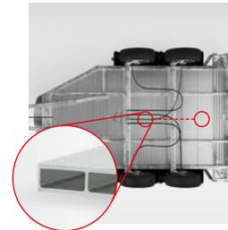
**Robust und unverrottbar** durch den massiven Qualitäts-Vollaluminiumboden zur Verstärkung im Pferdestandbereich.
